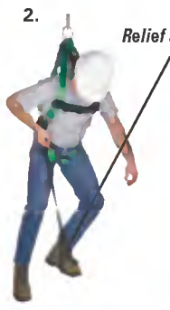
2. Insérer le pied dans la boucle et ajuster
